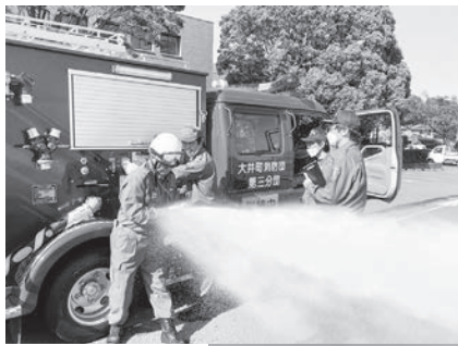
◀ポンプ性能検査の様子
