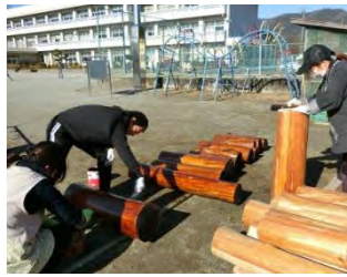
皮をむいた丸太に防腐剤を塗る
