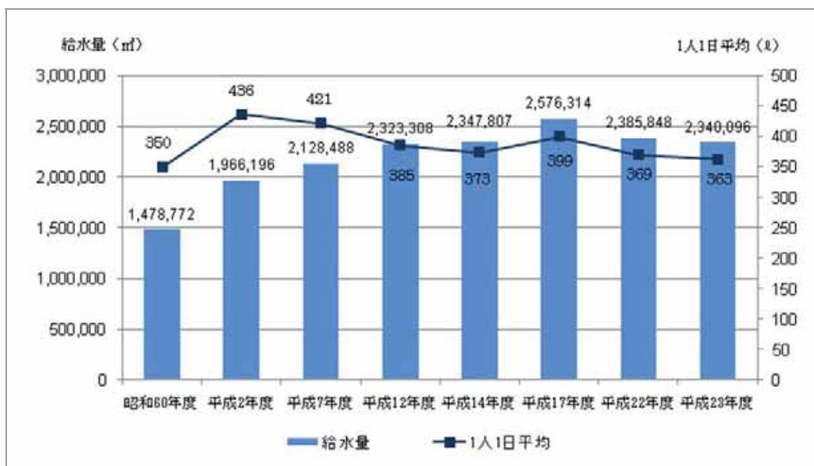
町営水道の給水状況の推移
