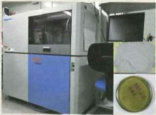
左：蛍光X線分析装置 (県立生命の星・地球博物館) 右中：岩石を砕いた粉末試料 右下：ガラス玉 (ガラスビードと呼ぶ)
